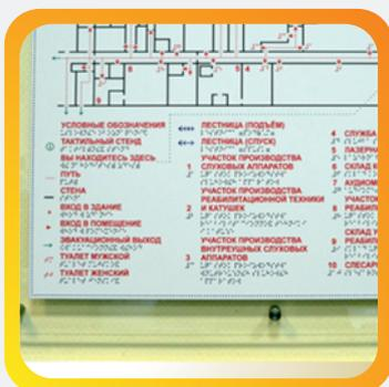
**Мнемосхема** – совокупность сигнальных устройств и сигнальных изображений, представляющих собой комплексную тактильную план-схему объекта, сочетающую в себе плоско-выпуклые элементы (очертания стен здания, путей движения и условных обозначений), а также надписи, выполненные шрифтом Брайля, предназначены для информирования, безопасности и ориентации в пространстве человека слабовидящего или с инвалидностью по зрению.
